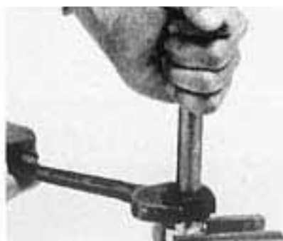
6. ゼロポイントから更に \frac{1}{4} ～1回転締付けると仮締作業は終了です。
