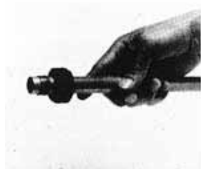
2. 管に袋ナット、スリーブの順に差し込みます。
