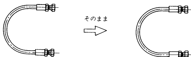
図19 ホースアセンブリの再取付け
